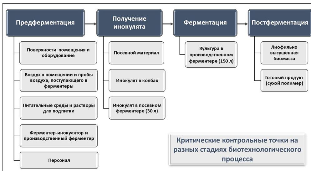
Рис. 2. Основные объекты микробиологического мониторинга биотехнологического опытного производства ПГА
