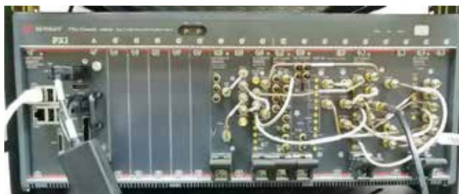
Рис. 6. Внешний вид задающего генератора на базе модулей PXI Keysight
