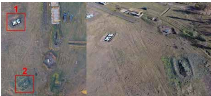
Рис. 4. Район дистанционного мониторинга с ложными объектами: 1 – макет БМП; 2 – макет танка под маскировочным комплектом МКТ-2
