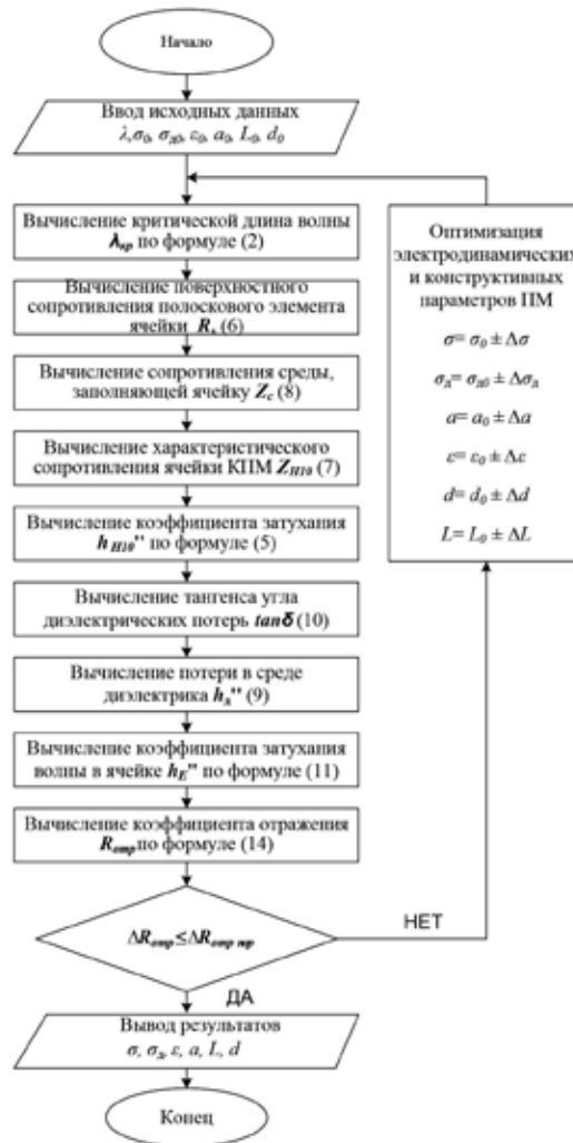
Рис. 3. Алгоритм определения электродинамических и конструктивных параметров поглощающего материала
