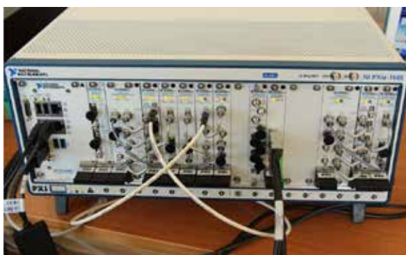
Рис. 5. Внешний вид задающего генератора на базе модулей PXI National Instruments
