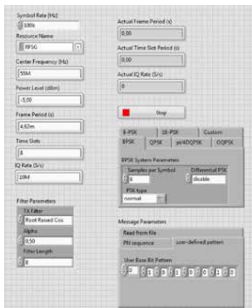
Рис. 2. LabVIEW VI фронт-панель управления сигналом РЛСВЗ
