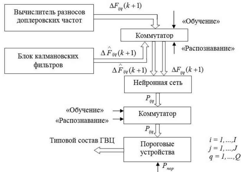
Рис. 4. Структура функционирования нейронной сети в режимах «обучение» и «принятие решения» о типовом составе групповой воздушной цели
