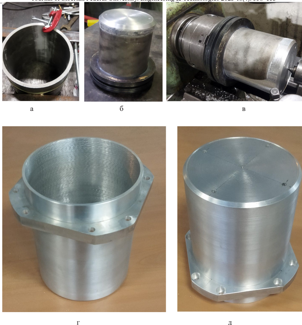
Рис. 15. Последовательность изготовления оптимизированной детали Корпус: а – трубная заготовка, согнутая из листа 8 мм на вальцах; б – сваренный цилиндрический корпус со сваренным торцом; в – токарная обработка; г и д – вид на готовую деталь Корпус
