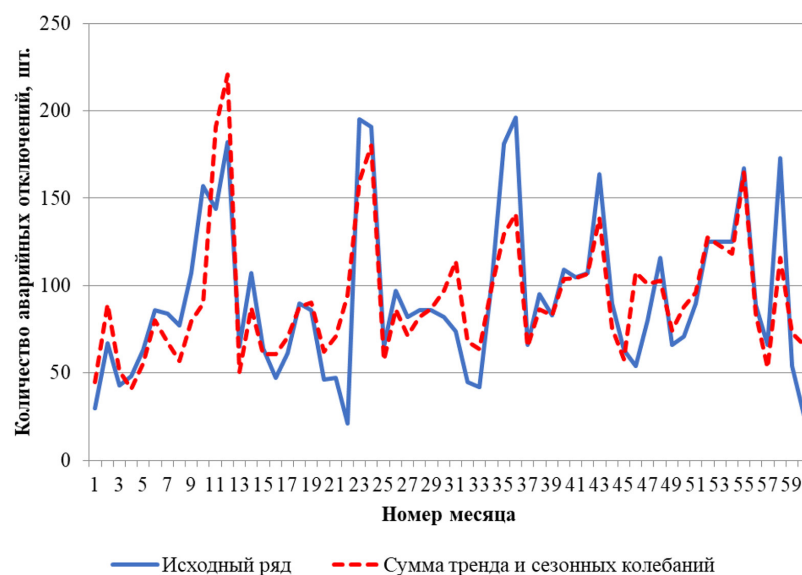
Рис. 7. Динамика аварийных отключений в сетях МЭ за 2019–2023 гг. и сумма тренда и сезонных колебаний, выделенных в тренд-сезонной модели
