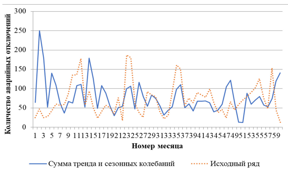
Рис. 9. Динамика аварийных отключений из-за несоблюдения сроков технического обслуживания в сетях МЭ за 2018–2023 гг. и сумма тренда и сезонных колебаний, выделенных в тренд-сезонной модели
